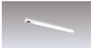
【共通仕様】 電源ユニット内蔵 定格電圧:AC100V~242V 平均演色評価数(Ra):83 光源寿命:40,000時間(光束維持率85%) 本体:照明器具 鋼板 白 カメラユニットケース:アルミダイカスト 白 LEDバー:ポリカーボネート 乳白
